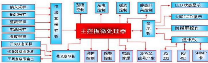
显示单元是将整机的运行状态和数据通过 LED 和 LCD 显示出来，同时还通过 RS232、RS485、CAN 总线、干接点信号、SNMP 卡等，配合后台软件实现远程监控。
