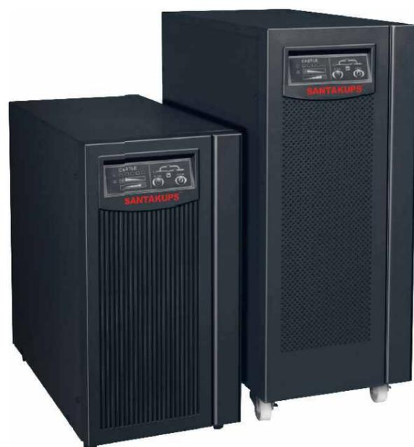
新城堡 (Castle) 系列在线式UPS, 包括容量1KVA至20KVA的一系列的UPS产品, 与在线互动式或后备式UPS相比, 在线式UPS能够为负载提供更佳的电源环境, 无论从稳压输出范围、频率范围、输入杂讯的滤除, 乃至市电模式与电池模式零转换时间等方面考虑, 在线式均是最佳的UPS结构, 因此, 重要的设备, 或是对电力环境要求苛刻的设备几乎都应选用在线式UPS。
